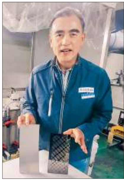
배명직 기양금속공업 대표가 독자 개발한 흑색 스테인리스(오른쪽)와 기존 스테인리스(왼쪽)를 비교하며 설명하고 있다.
